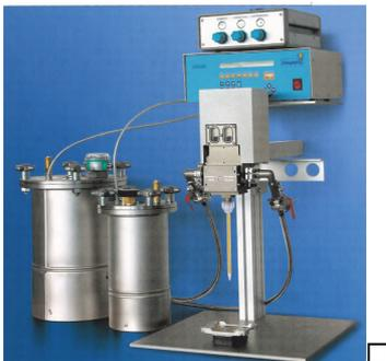
**Mehrfach-Dosierköpfe** statische Mischer für hohe Dosierleistungen.
