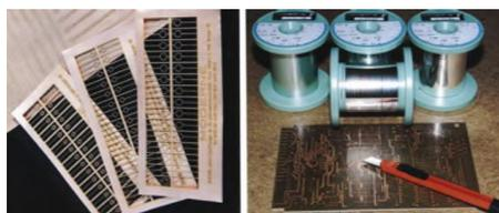
Schweißbänder für die Leiterbahnenreparatur mit Oxidationsschutz aus Silber oder Gold, in vielen Abmessungen ab 50 µ Breite verfügbar.
