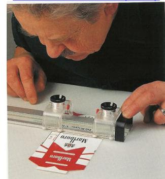
Maximaler Längenfehler 0,013 mm auf 500 mm.
