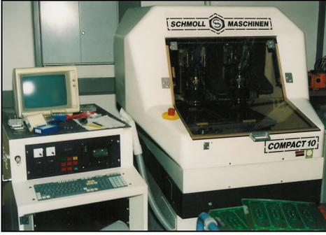
**SCHMOLL** 2-Spindel Bohr- und Fräsmaschine
